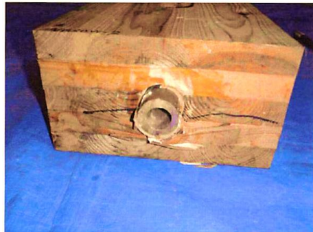
鋼管と接着剤の付着の抜け出し No2
